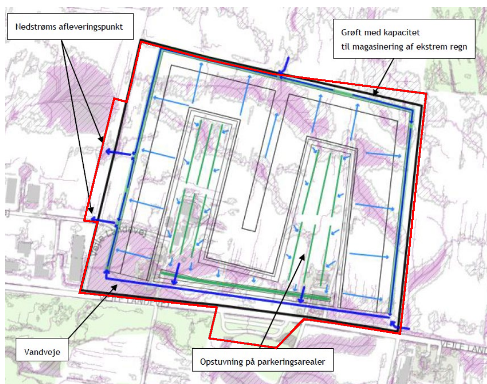
Figur 9-8: Skitse over eksisterende strømningsveje på terræn (lilla) og skitserede fremtidige vandveje (blå og lyseblå pile) for plan- og projektområdet nord for Vejle Landevej ved ekstremregn (Envidan, 2025). Planområde vist med sort og projektområde med rødt.
